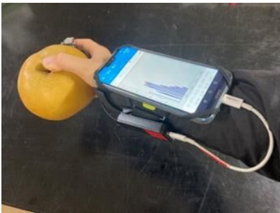
1点式振動硬度計によるみつ 症判別の様子
