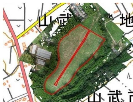
QGIS を用いて、国土地理院電子地図上にオルソ画像と森林整備地域の実測図を重ね合わせた状態
