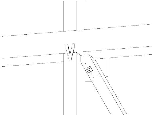
図 II.2.2.3 柱頭接合部の例
