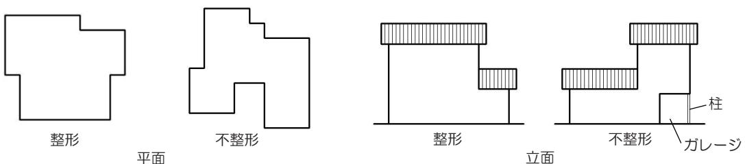
図 II.2.2.1 平面形状および立面形状
